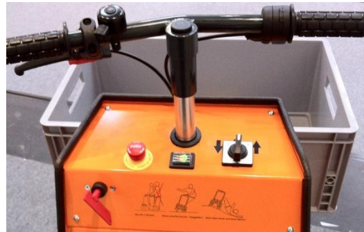
Einfache und sichere Bedienungselemente mit Hauptschalter, Not-Aus-Schalter, Batterieanzeige und Vor- und Rückwärtsschalter.
